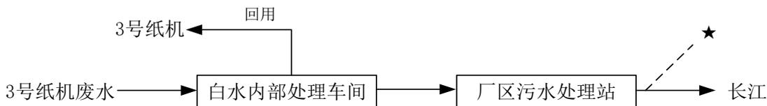
图 4-1 废水处理及排放流程（附“★”废水监测点位示意图）
