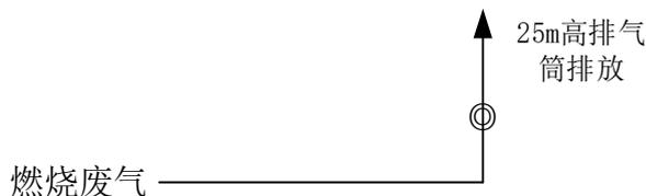
图 4-2 废气处理及排放流程（附“⊙”废气监测点位）
